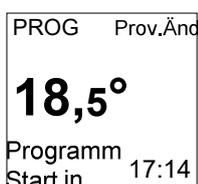
Sie können die ECO-Temperatur ändern, sodass Sie die Standardeinstellung zwischen der Komforttemperatur und der ECO-Temperatur festlegen müssen. „PROG Prov.Änd.“ wird bis zum nächsten Komfortbereich angezeigt.
