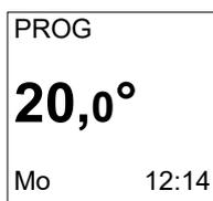
Wenn auf dem Bildschirm PROG angezeigt wird, befinden Sie sich in einem Programmierbereich im Komfortmodus.
