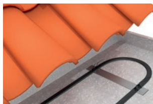
Abstandhalter bei der Doppelverlegung des Dachrinnenheizbandes.
